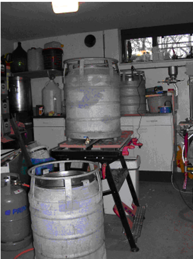
Figuur IV.4: Filterketel van gammel.
