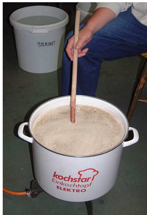
Figuur 4.14: Geëmailleerde wekketel in gebruik als maischketel.
