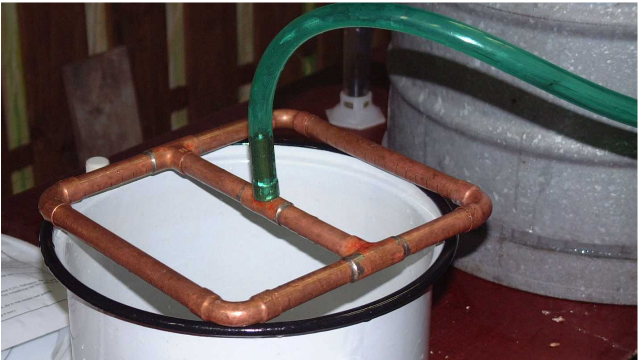
Figuur 4.19: Hevelfilter (verschillende uitvoeringsvormen)
