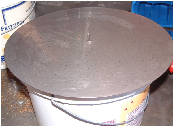
Figuur 4.17: Filterbodem van RVS.
